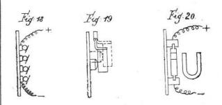
En el Dumon los lápices horizontales se reemplazan por dos carboncitos verticales unidos por una pieza metálica sujeta á un gancho. Esta suspensión puede ser desviada á voluntad, á fin de poder disponer la presión de los contactos microfónicos como en el de Blake.
