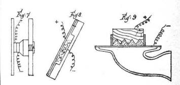
Compónese el micrófono Berton (fig. 8.ª) de una membrana vibrante inclinada ligeramente, contra la que se hallan dos gránulos de carbón que descansan en una placa conductora.
