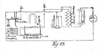
Cuando se funciona con la manivela, la bobina del generador entra en acción hasta el momento en que deje de producirse la llamada.
