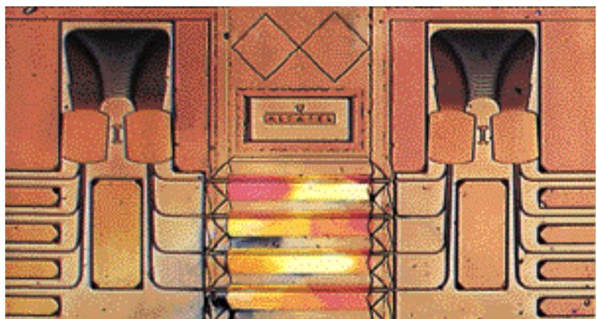
Figura 10 – Selector de longitud de onda totalmente InP.
