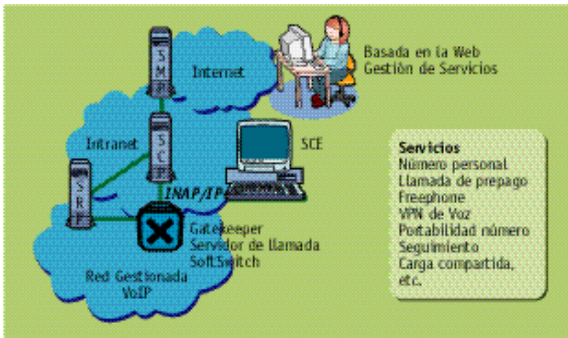
Figura 6 – Componentes IN en un entorno de servicios de VoIP
