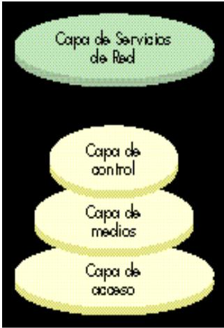
Figura 1 – Las cuatro capas del modelo de red funcional.
