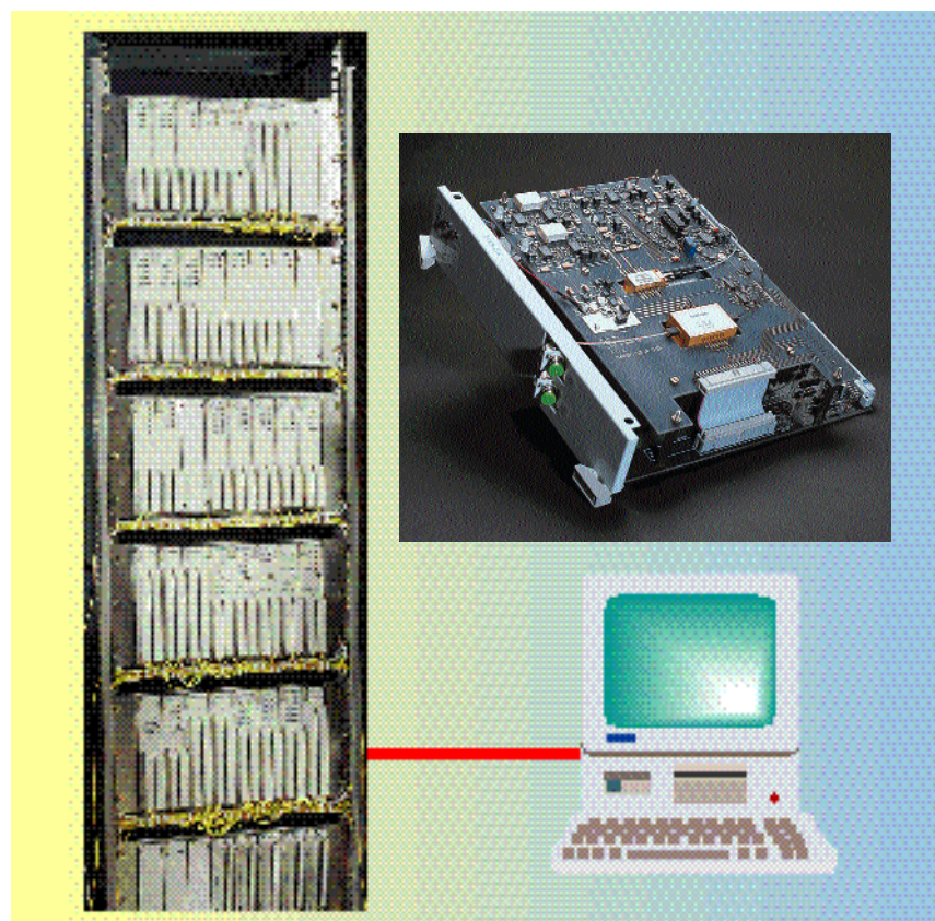
Figura 4 - Placa de conversión de longitud de onda y WT-OXC montado en bastidor.
