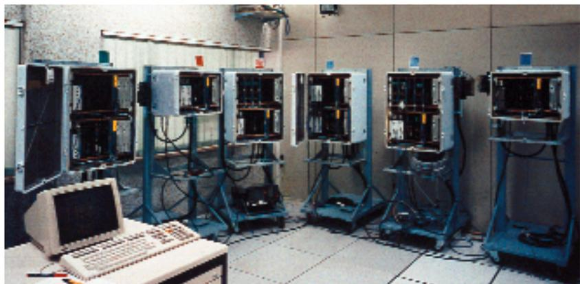
Foto 2 - Verificación del equipo de acceso radio de Alcatel para el proceso de homologación.
