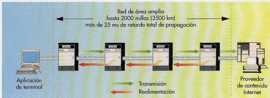
Figura 4 - Parámetros de un bucle de realimentación de WAN
