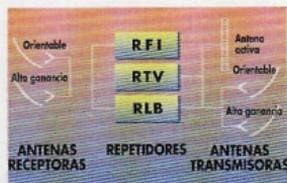
Figura 3 - Carga útil del STENTOR
