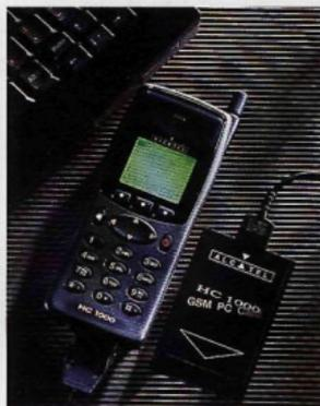
Transmisión de datos o de fax con la tarjeta PC del GSM Alcatel HC 1000
