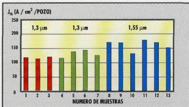
Figura 2 - Densidad de corriente umbral,  $J_{th}$ , para láseres de gran área QW de 300  $\mu\text{m}$  de largo con dos diseños diferentes de 1,3  $\mu\text{m}$  (muestras 1 a 7) y un diseño de 1,55  $\mu\text{m}$  (muestras de 8 a 13)
