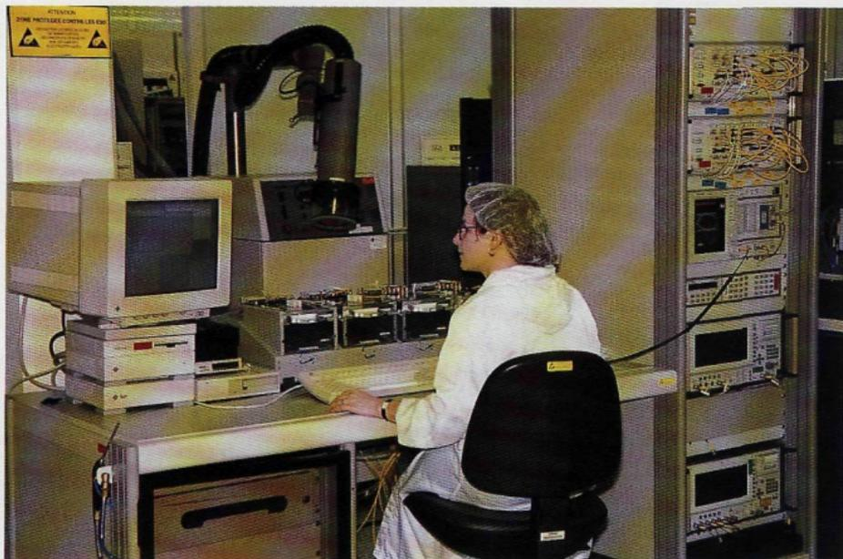
Foto D - Banco de pruebas finales para módulos Alcatel 1911 SDH y 1914 SDH
