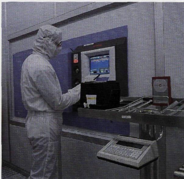
Figura 8 - Validación múltiple de lotes por medio de lector de tarjeta basado en radio frecuencia
