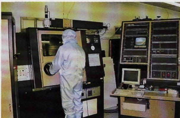
**Foto A - Sellado YAG para módulos discretos**
