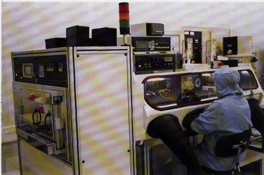
Foto F - Soldadura de tapa de productos coaxiales, con soporte de alto vacío y control de proceso estadístico en línea
