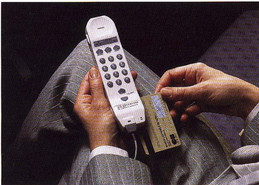
Foto A - Aparato telefónico de cabina con lector de tarjetas de crédito
