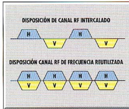
Figura 1 - Canalización intercalada y reutilizada
