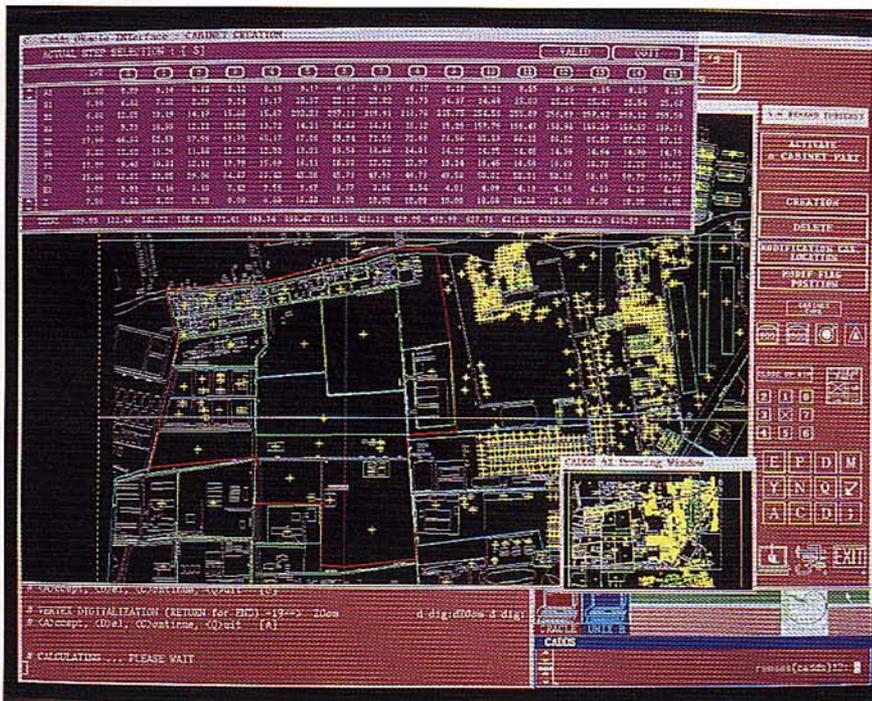
Foto A - Un interfaz de usuario asequible, informaciones gráficas vinculadas a una base de datos relacional permiten un diseño de la red en tiempo real. En este caso, estudio de la zona de influencia de un sub-repartidor en función de la demanda prevista.
