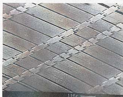
Figura 8b - Vista en planta de una oblea OEIC láser/supervisor; los "rectángulos" grandes son los láseres, los pequeños son los detectores de supervisión.
