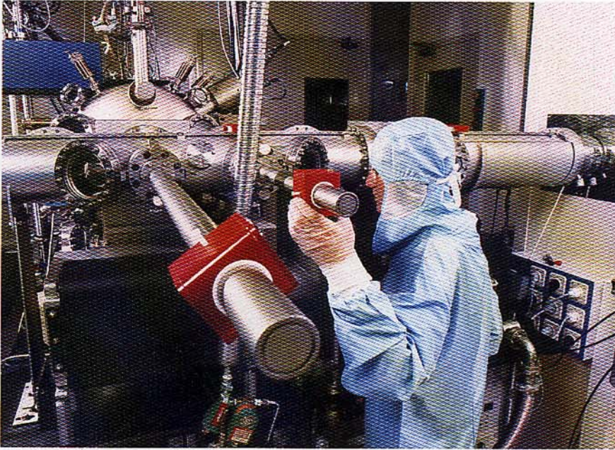
Epitaxia por haces moleculares: equipo diseñado y desarrollado por Alcatel Alsthom Recherche, empleado en la actualidad por Alcatel CIT para la producción de diodos láser de pozo cuántico.
