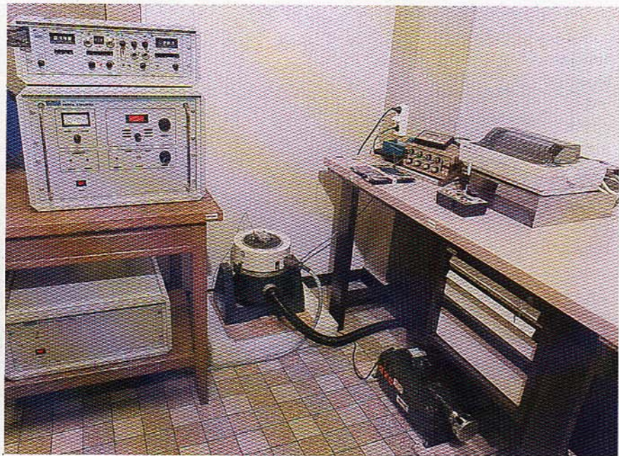
Medida de la sensibilidad de vibración.
