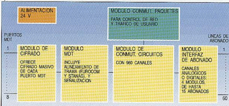
Figura 2 Diagrama de bloques de la centralita táctica de la Serie 300.
