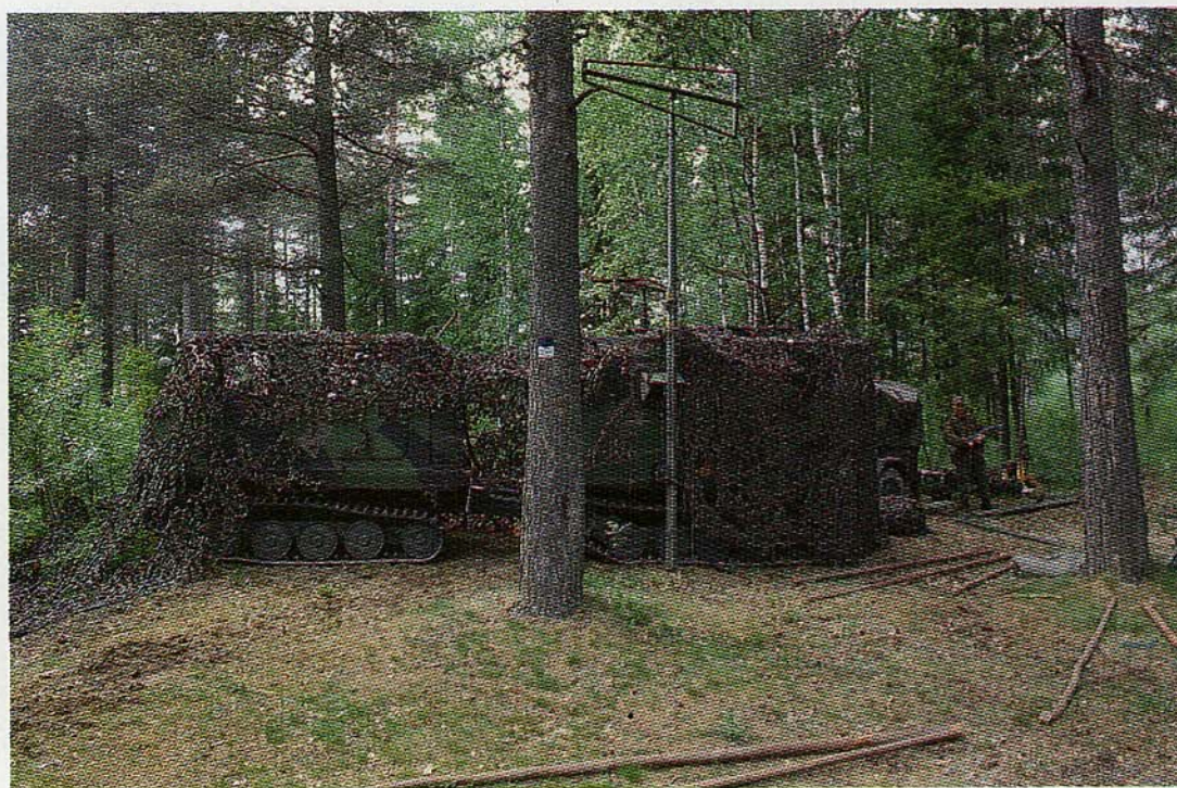
Nodo de gran movilidad de la red táctica Alcatel 101 instalado en vehículos oruga.
