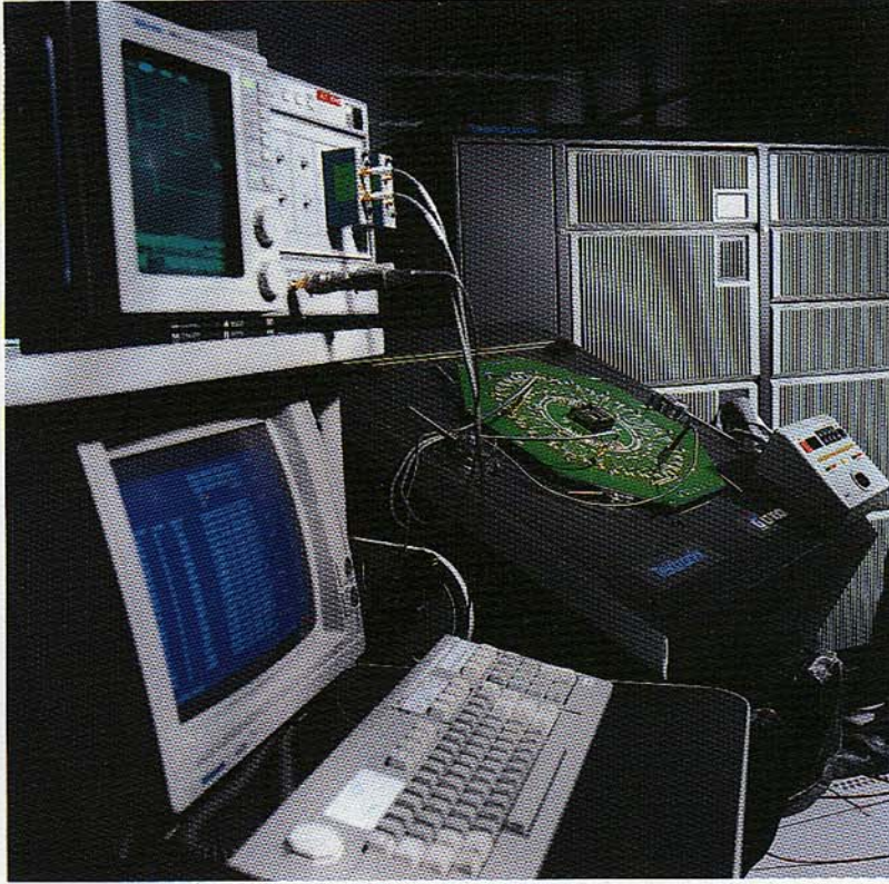
Dispositivo RDSI de banda ancha (puerto transmisor-receptor) siendo caracterizado a 150 MHz en un entorno integrado de prueba.
