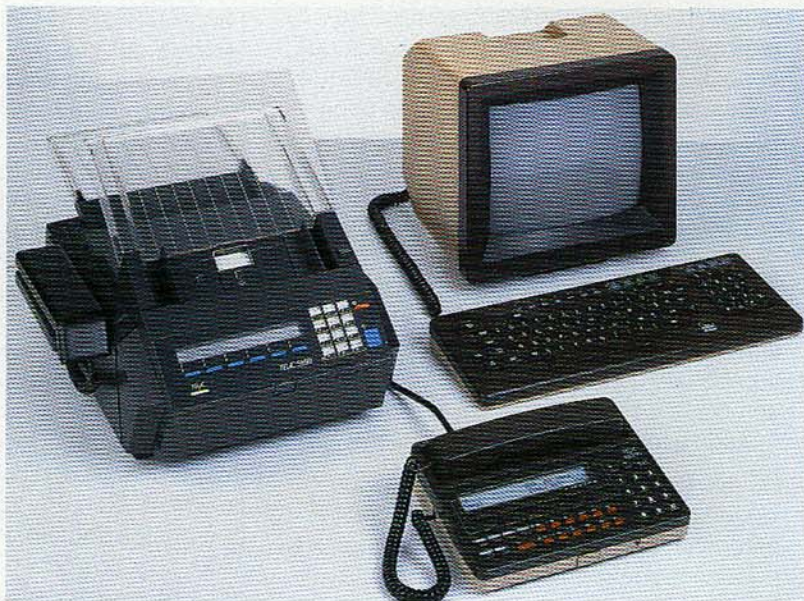
Ejemplo de las facilidades que pueden ofrecerse al usuario combinando un teléfono digital, un terminal de pantalla y un facsímil, conectados todos al 2600BCS de Télec por el mismo cableado telefónico.
