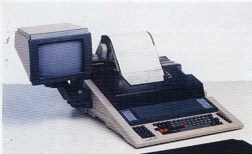
Máquina télex modelo TL 53 con pantalla CRT de 9 pulgadas exenta de parpadeo.
