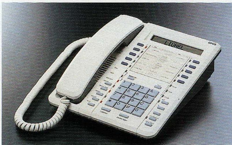
Aparato telefónico digital 4031, utilizado con el Opus4000 de Téléc. El cuidado diseño de la pantalla, los LED y teclas programables, junto con el canal de señalización, potencian el interfaz hombre-máquina y facilitan el acceso del usuario a una extensa gama de servicios.
