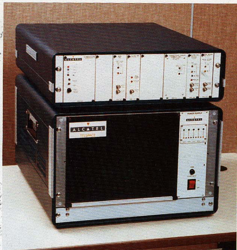
Terminal TDMAX compacto para AMDT de 3 a 25 Mbit/s.
