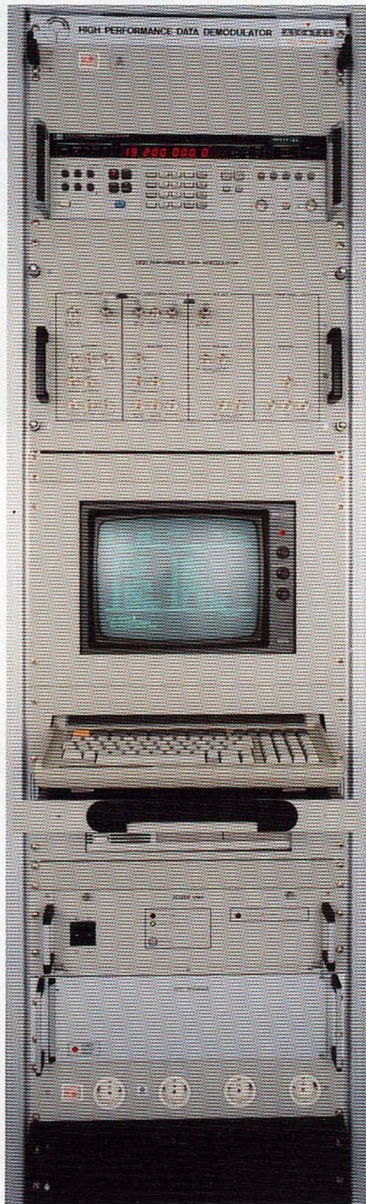
Demodulador de datos de alto rendimiento desarrollado por Alcatel Bell para misiones espaciales como la sonda Giotto que se aproximó al cometa Halley.
