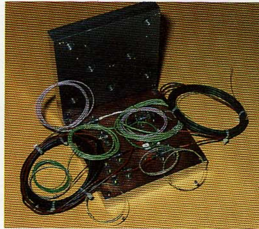
Conectores ópticos montados en la base en forma de L para la prueba de choque mecánico.
