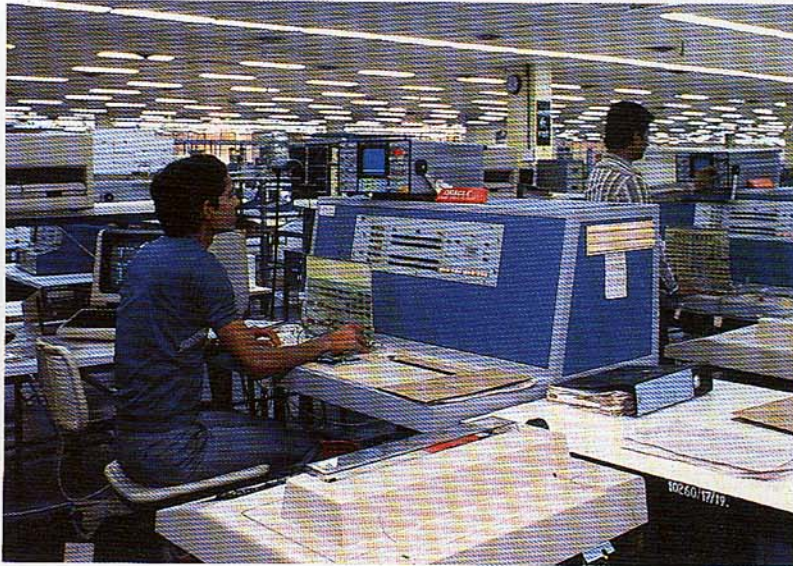
Inspección y prueba automatizada de placas impresas E10 en la fábrica de Mankapur.
