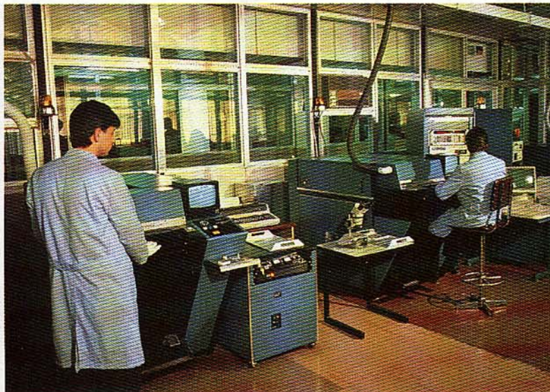
Máquinas recortadoras por láser para fabricación de circuitos de película gruesa.
