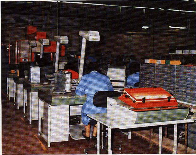
Estaciones de montaje manuales con ayuda óptica, controladas por ordenador, para ensamblaje de equipo electrónico.
