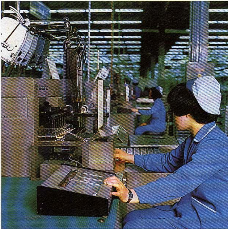
Operación de cablear los puntos de cruce del Metaconta 10CN en la fábrica de Gumi.
