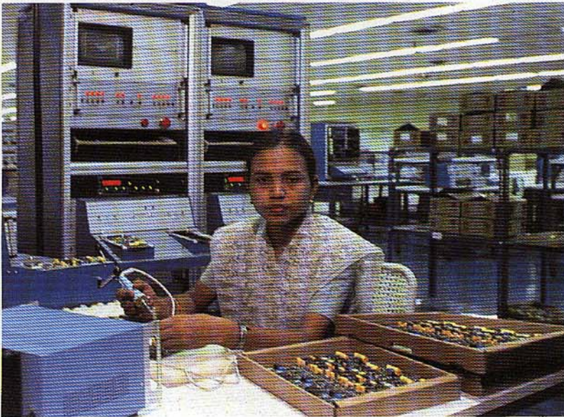
Placas impresas defectuosas reparadas en la fábrica de Mankapur.
