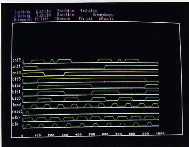
Salida de simulador: formas de onda que expresan el comportamiento del circuito.
