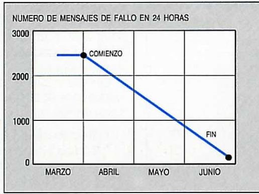
Figura 5 Reducción del número de mensajes de fallo en una central de prueba como resultado de introducir el AMF.
