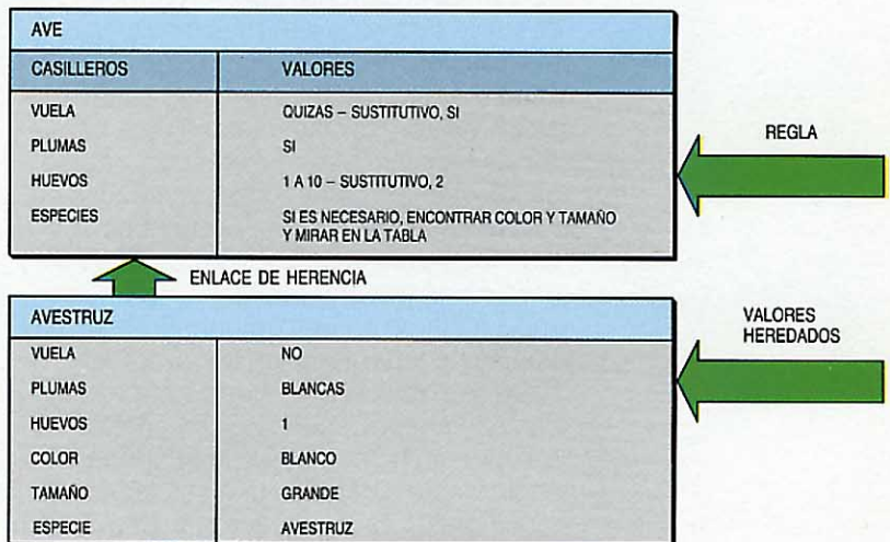
Figura 6 Representación de conocimientos por medio de tramas, que combinan los conceptos de reglas y redes semánticas.
