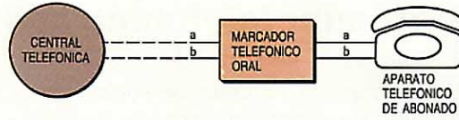
Figura 1 Interconexión de un marcador telefónico oral con el aparato telefónico del usuario y la red telefónica.
