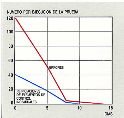
Figura 3 Pruebas de integración del sistema: número de errores y de reiniciaciones de elementos de control aislados durante las dos primeras semanas de funcionamiento de los modelos de laboratorio.
