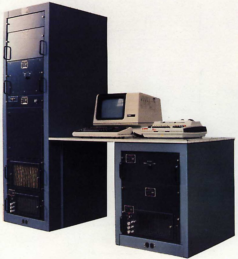
Radiobaliza TACAN de estado sólido 9996-G, de ITT Avionics.
