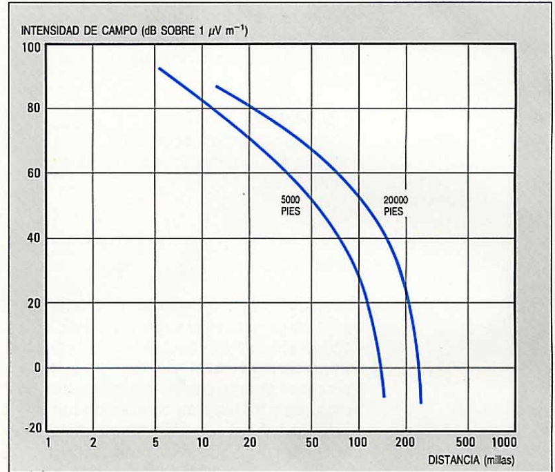
Figura 1 Intensidad de campo en función de la distancia, para antenas en aviones a 5000 y 20000 pies de altura. Las curvas corresponden a una potencia radiada de 1 kW con la antena emisora a 60 pies sobre el nivel del suelo.
