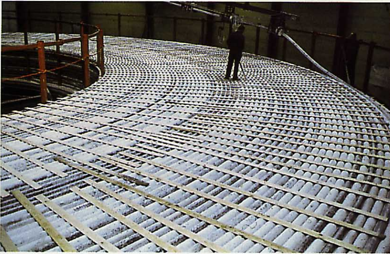
Plataforma giratoria en la planta de cable submarino de STK; puede almacenar hasta 6.500 toneladas de cable.
