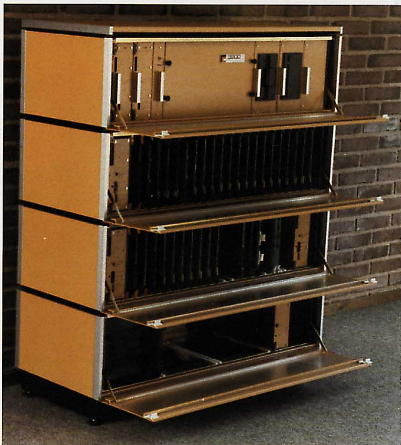
Conjunto Databocs, mostrando los armazones de la centralita y el del microprocesador.
