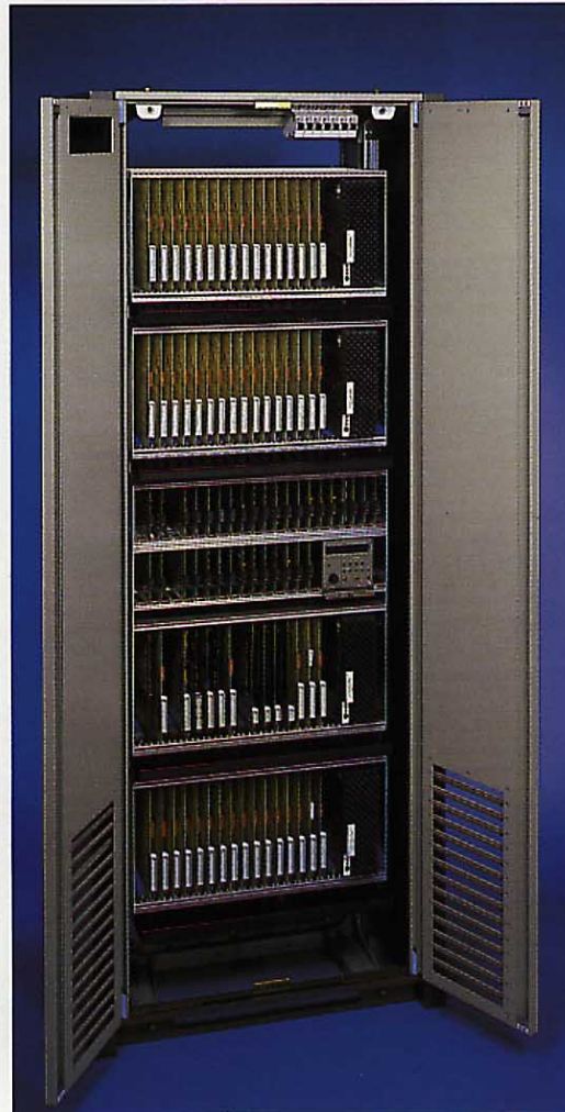
Armario del sistema ITT 5500 cuyas puertas abiertas descubren los cuadros equipados.
