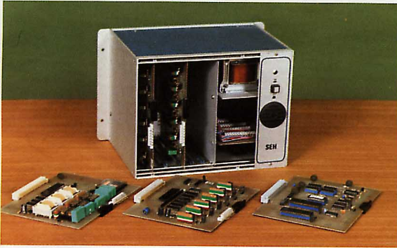
Centralita, quitadas las tarjetas de circuito interfaz de enlace, circuito interfaz de extensión y unidad central de proceso.
