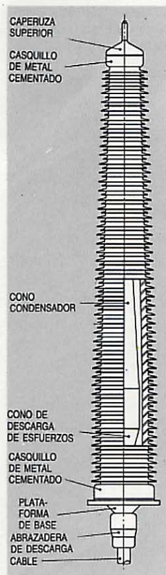
Figura 1 Diseño del extremo protector con cono condensador.
