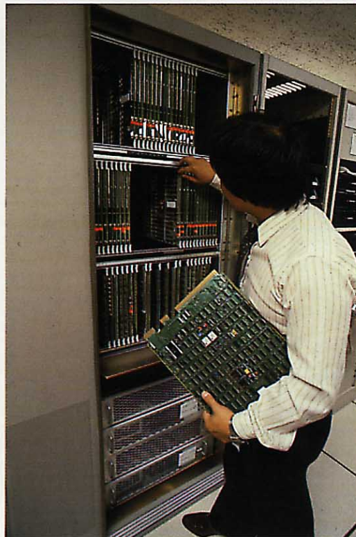
Aspecto del procesador de entrada utilizado para el servicio Faxpak, que proporciona la compatibilidad necesaria entre terminales de facsímil de distinto tipo.
