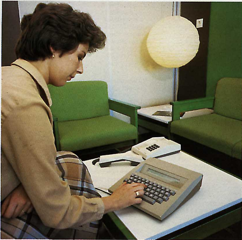
El teléfono de textos de NSEM permite comunicarse en ambos sentidos a personas con dificultades para oír o hablar.
