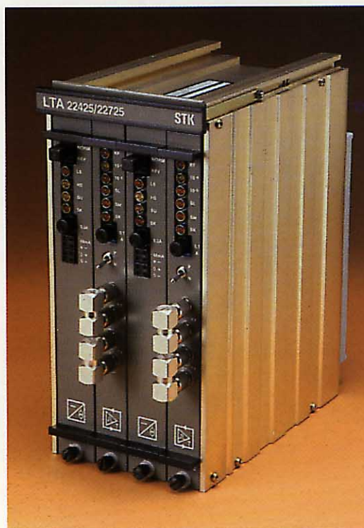
Equipo de terminación de línea.
