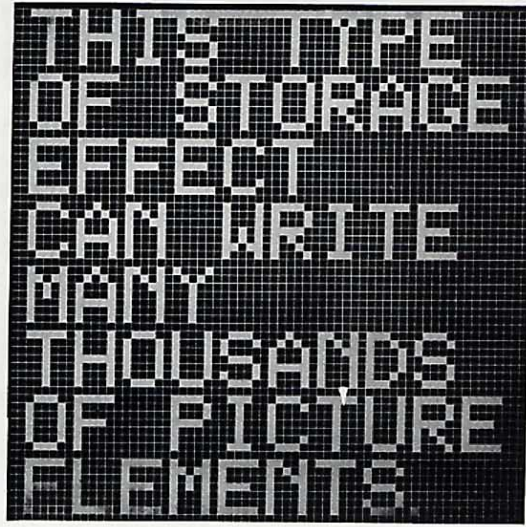
Figura 7 Prototipo de pantalla esmética con barrido electrónico desarrollada en STL.
