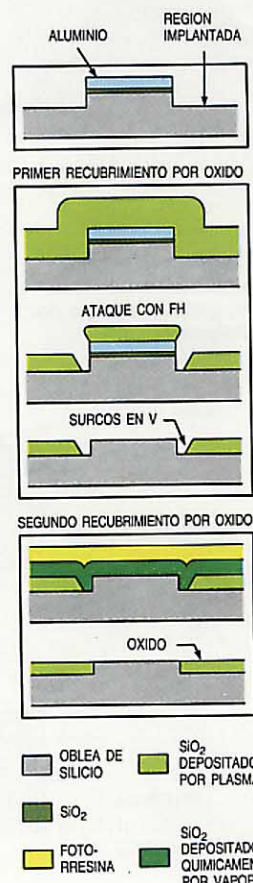
Figura 4 Proceso de fabricación de óxido enterrado.
