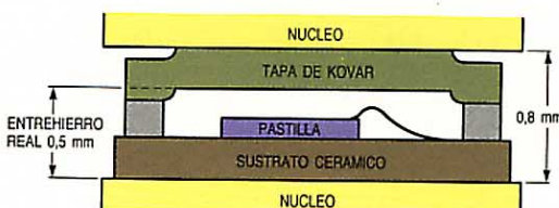
Figura 2 Encapsulado de bajo perfil de un dispositivo de efecto Hall, mostrando la pastilla de silicio fresada por debajo, el conexionado y la tapa magnética.
