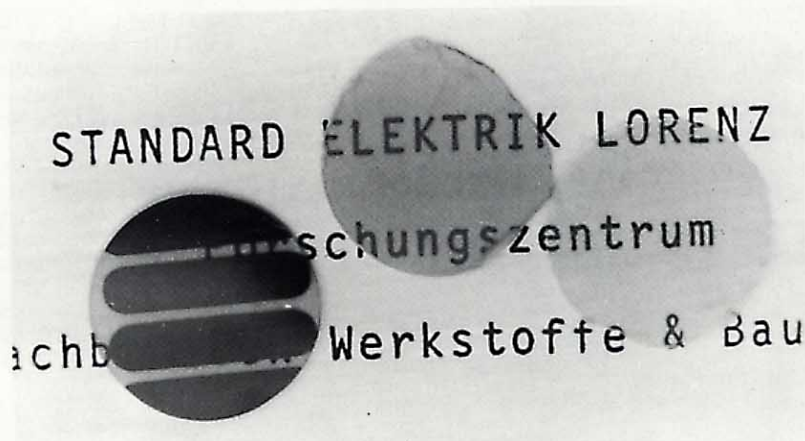
Figura 3 Discos triturados y pulidos de cerámicas BLTN 20; el de la izquierda ha tenido electrodos evaporados en la superficie.
