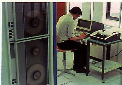
Comunicación hombre-máquina en la central ITT 1240. En primer término, las unidades de cinta magnética.
