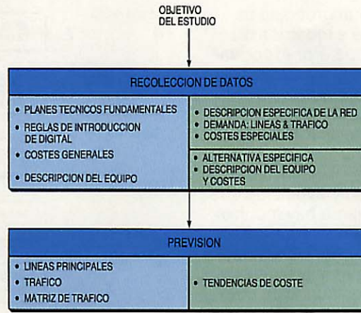
Figura 9 Esquema de los pasos iniciales en un ejercicio de dimensionado/optimización de red.
