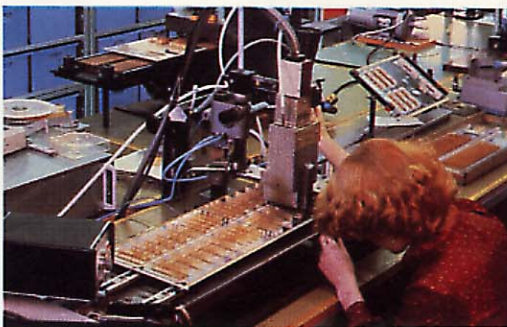
Figura 8 Vista general (arriba) de la inserción de terminales macho en un panel posterior, y (abajo) detalle de la máquina de inserción.
