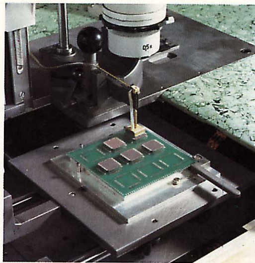
Figura 5 Máquina de manejo y posicionado para montaje de los portadores de circuito con terminales preformados, sobre placa de circuito impreso.
