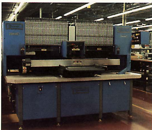
Figura 1 Inserción automática de componentes para placas de gran volumen de pro- ducción.
