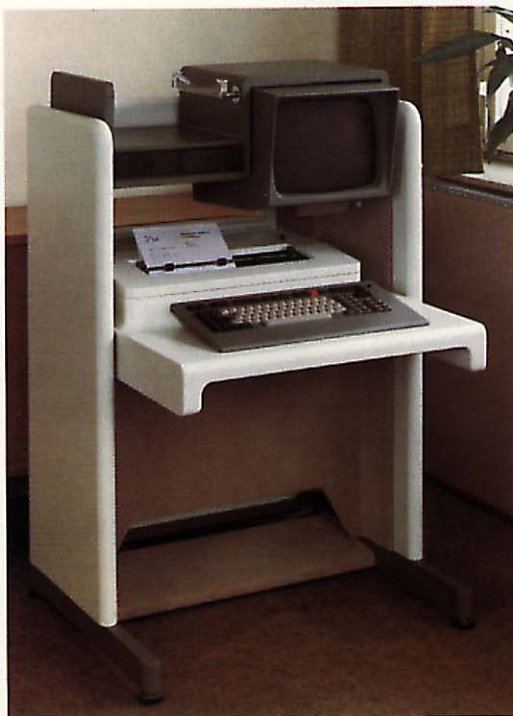
Figura 3 Terminal teletex desarrollado por SEL. Incorpora un teclado completo, unidad de pantalla, impresora de tipo margarita (daisy-wheel), dos minidiscos flexibles y control por microprocesador de las funciones locales del terminal y de las funciones de comunicación.
