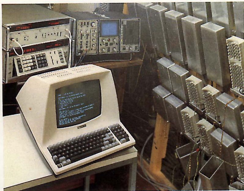
Banco de pruebas de cables en el laboratorio de transmisión de STL, mostrando algunas de las terminaciones de cable y el equipo de prueba asociado.
