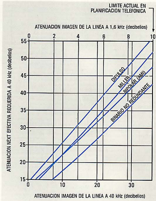
Figura 8 Comparación de la sensibilidad a la diafonía de extremo cercano para cuatro códigos de línea, a una velocidad de información de 80 kbit s -1 . Las curvas corresponden a un cable de cobre de 0,5 mm transportando una secuencia aleatoria de bits, con una tasa de error en bits de 10 -1 ; diafonía de extremo cercano 4,5 dB por octava, con distribución gaussiana en el punto de decisión; espectro en coseno potenciado a la velocidad de transmisión; no se incluye margen.
