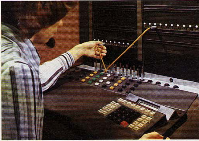
El sistema OPAS-II para automatización de posiciones de operadora. Esta unidad controlada por microordenador y conectable a las posiciones puede emplearse con casi todos los cuadros de conmutación manual para mejorar el servicio que prestan las operadoras.
