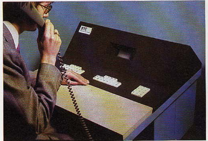
Un probador remoto de líneas que puede ser utilizado para prueba de líneas desde una posición central sobre cualquier tipo de medio de transmisión.
