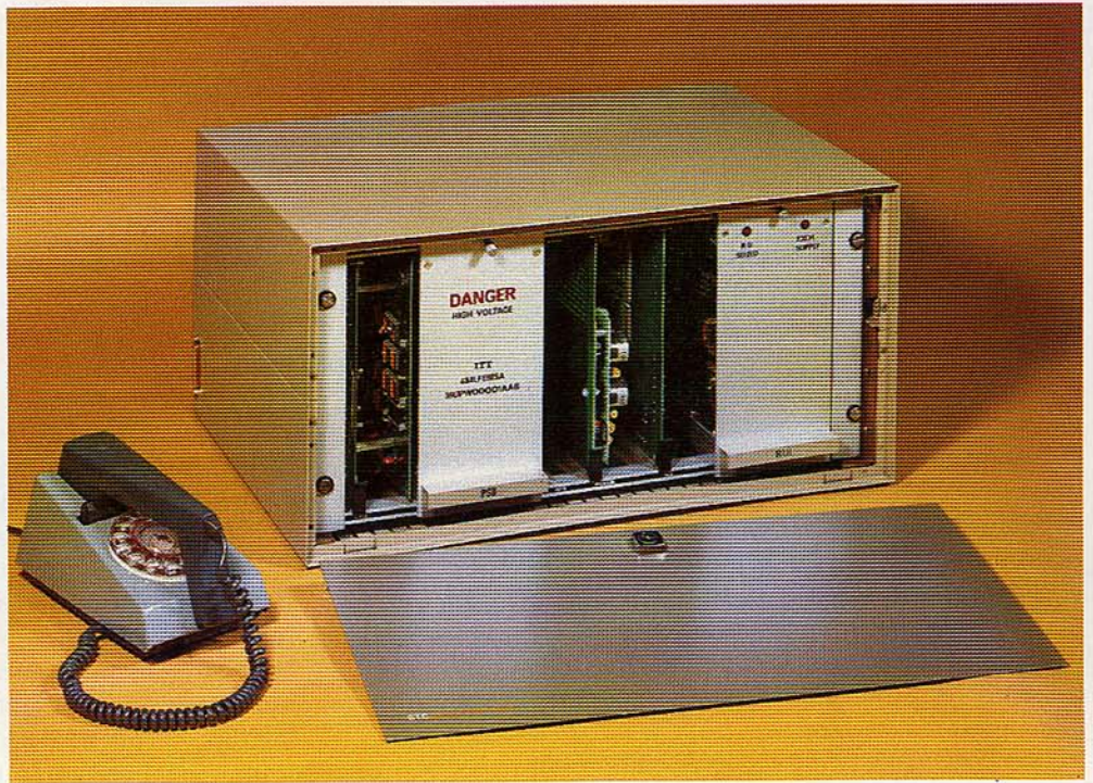
Unidad distante del equipo de pruebas de líneas a distancia mostrando las unidades enchufables.
