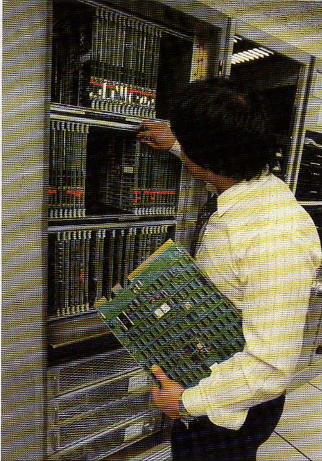
Vista del procesador de entrada empleado en el servicio FAXPAK. Proporciona toda la compatibilidad necesaria entre terminales facsímil diferentes.
