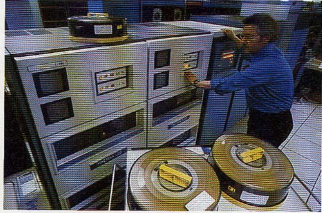
Carga de una unidad de disco en el disco de cabezas móviles que actúa de memoria de masa en el sistema télex TIMETRAN.
