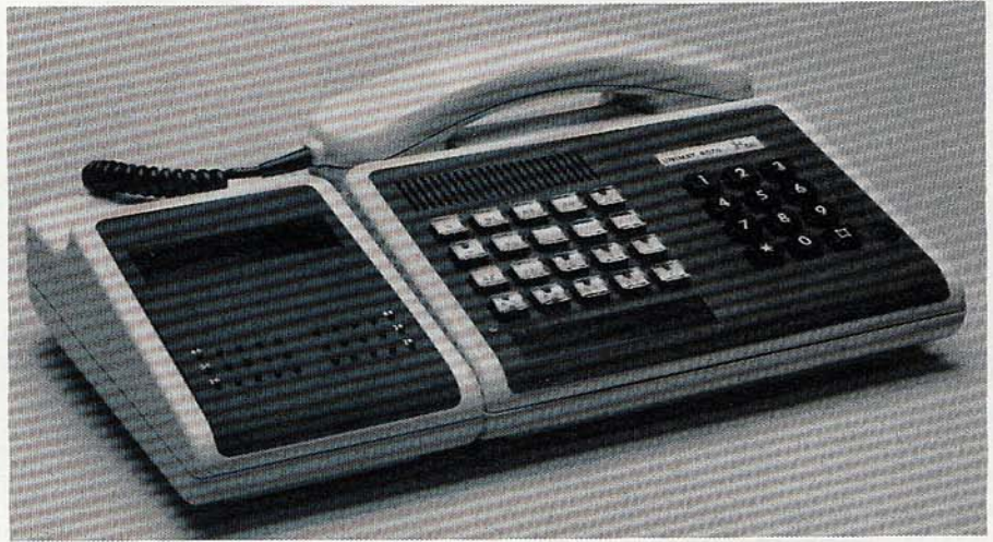
Posición de operadora en la versión 2 W 30 de la PABX UNIMAT 4070.
