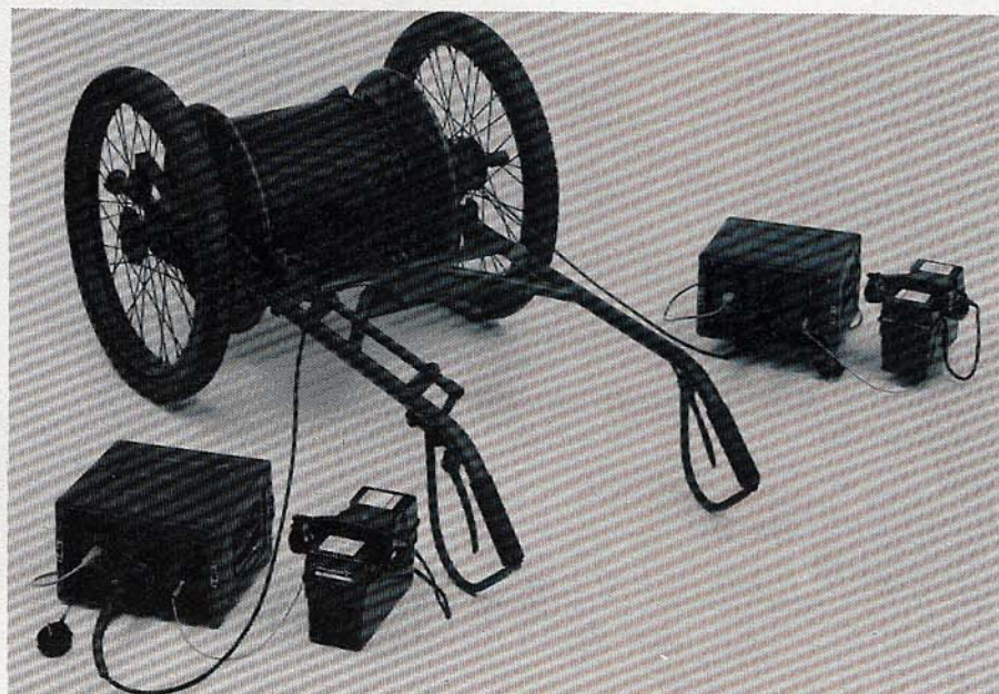
Sistema de transmisión por cable de fibras ópticas desplegable en el campo, que funciona entre 256 y 1.152 bit/s. Los aparatos telefónicos para el canal de servicio se conectan a las unidades de terminación de línea.
