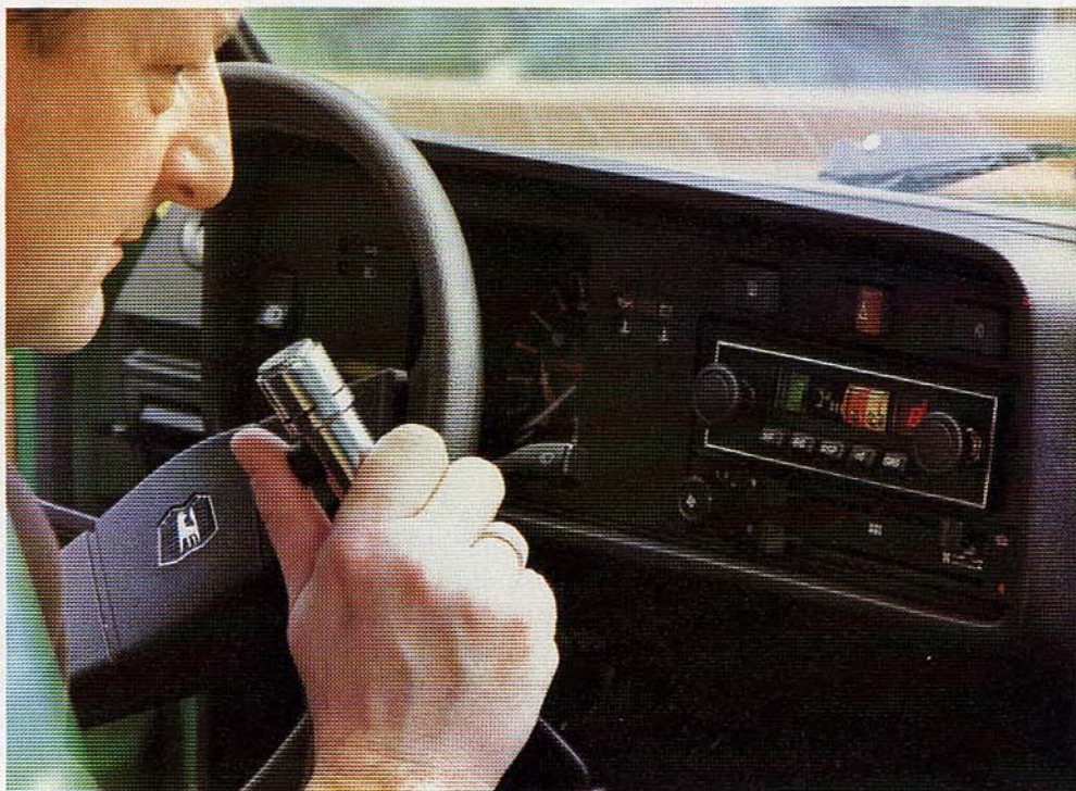
El nuevo equipo de radio móvil SE 205 desarrollado por SEL. Emplea técnicas modernas de síntesis de frecuencia para realizar un dispositivo que proporciona un gran número de canales, siendo pequeño y de poco peso.
