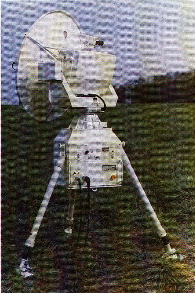
El sensor del radar móvil Zephyr A mostrando la antena, unidad transmisora-receptora y mecanismo de elevación, debajo del cual se encuentra la unidad de servo y seguimiento.
