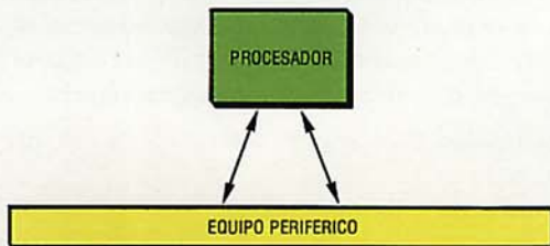
Fig. 1 Esquema de un sistema de monoproceso; el procesador puede estar duplicado para aumentar la fiabilidad.
