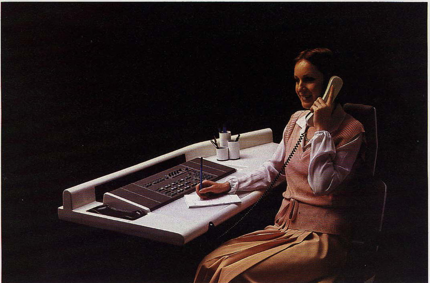
Consola de operadora para la UNIMAT 4080 PABX. Al diseñar esta consola ITT puso especial cuidado en factores humanos tales como comodidad de la operadora, claridad de la presentación de la información y facilidad de los controles. Estas características garantizan que la consola puede ser operada durante largos períodos sin excesiva fatiga.
