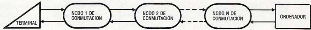
Fig. 6 Camino de comunicación, entre un terminal y un ordenador, utilizado para el análisis de eficiencias.
