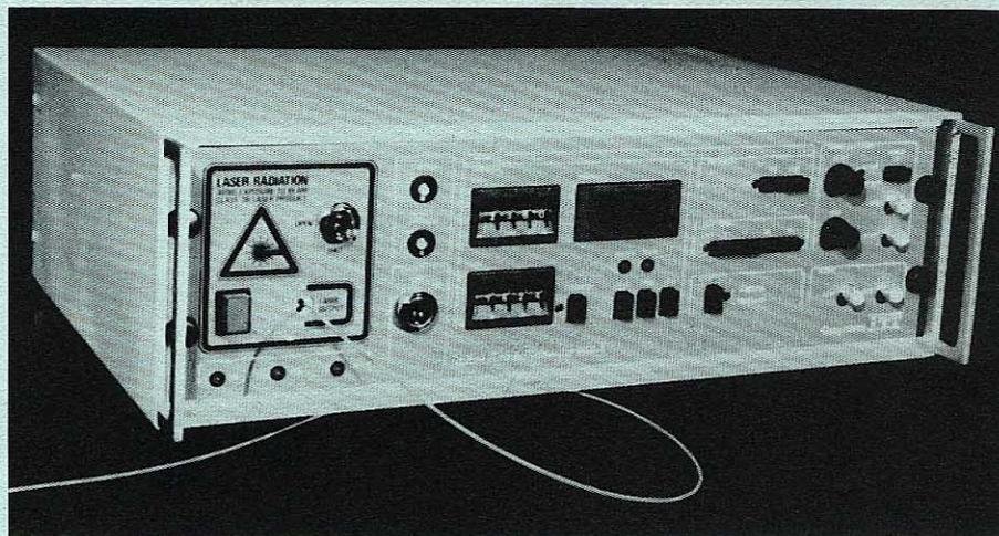
Reflectómetro para fibras ópticas.
