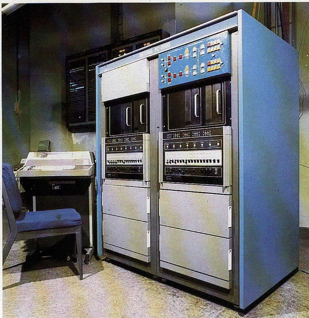
Fig. 1 Multirregistrator con programa almacenado que forma parte del PC-2000. El teleimpresor se usa para comunicación hombre-máquina.
