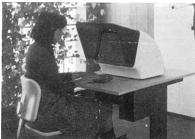
Fig. 7 Pupitre de codificación equipado con teclado y pantalla de control. Los mensajes aparecen en la zona oscura comprendida entre las dos imágenes.
