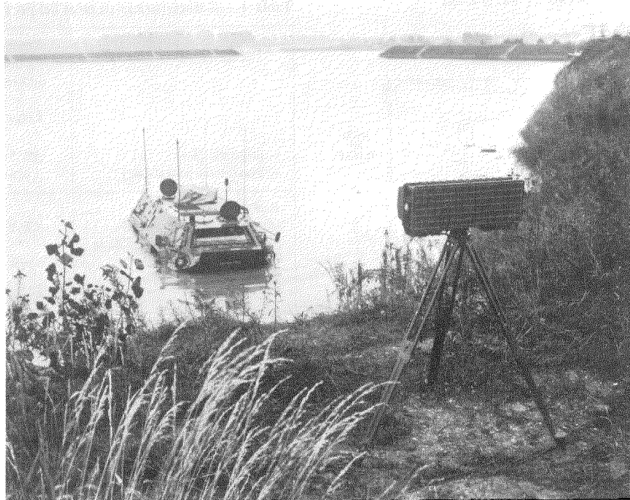
Fig. 6 Protipo SEFAN durante las pruebas de campo. Se muestra el respondedor montado sobre un trípode en el suelo. En el vehículo anfíbio puede verse las dos antenas SEFAN, a mano izquierda de la fotografía y las antenas de comunicación, a la derecha.
