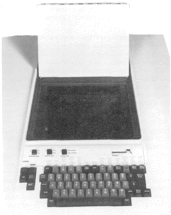
Fig. 4 El sistema de entrada de datos ITT 3470 mostrando el teclado y una unidad de representación visual.
