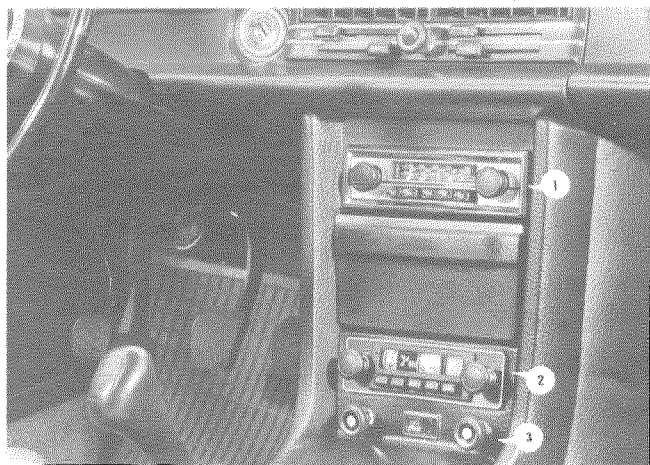
Fig. 2 Equipo radiotelefónico SE205 instalado en un coche como un receptor de radio.
