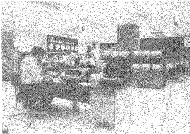
Fig. 2 Centro de Control de Comunicaciones de ITT Worldcom en Nueva York, con el terminal de TRC de supervisión del Sistema Central de Alarmas en primer término.
