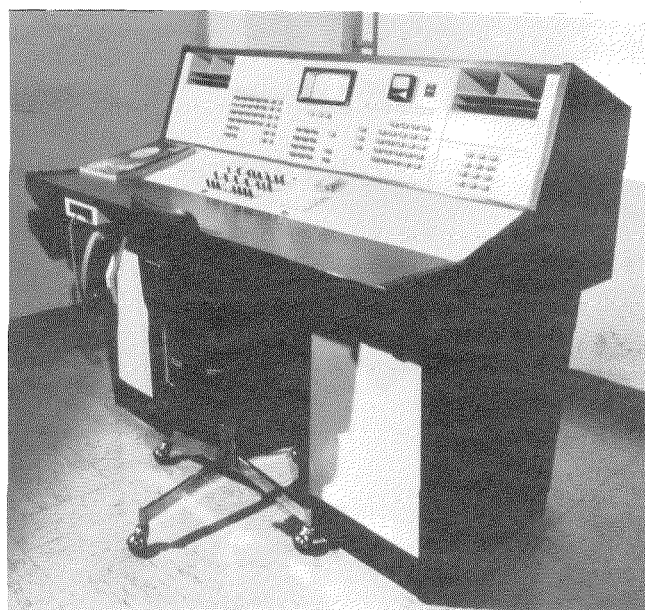
Fig. 1 La central telefónica electrónica METACONTA 10 C, Hamilton III, controlada por ordenador, permite el acceso telefónico automático a todo el mundo. Situación geográfica.
