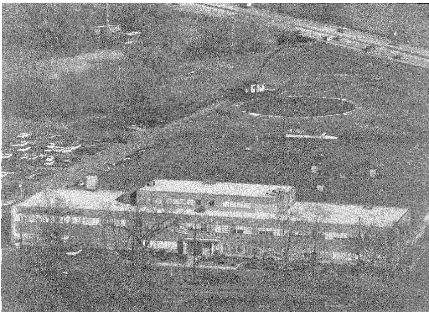
Fig. 1 Dispositivo para prueba de antenas de banda ancha.
