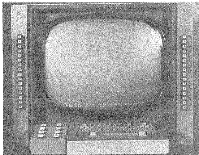
Fig. 9 Trazador de aproximación con indicación de dirección, circuitos de almacenamiento, rumbos, trayectoria, etc.
