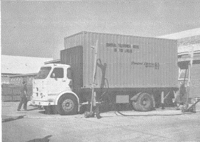
Central móvil de 700 líneas tipo PC 32 instalada en un contenedor de 20 pies, dispuesta para su transporte en camión.
