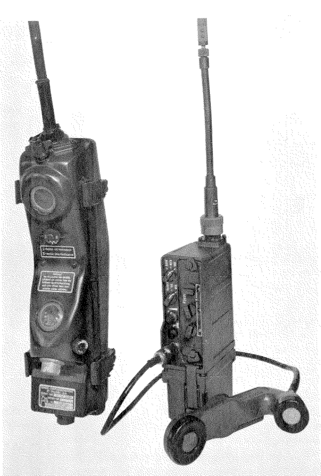
Fig. 16 Transmisores-receptores portátiles; izquierda: PRC 6-6, 0,25 W, 6 frecuencias seleccionables en la banda 47-55,4 MHz; derecha: equipo de 400 canales, 0,1/1 W en la banda 47-57 MHz.
