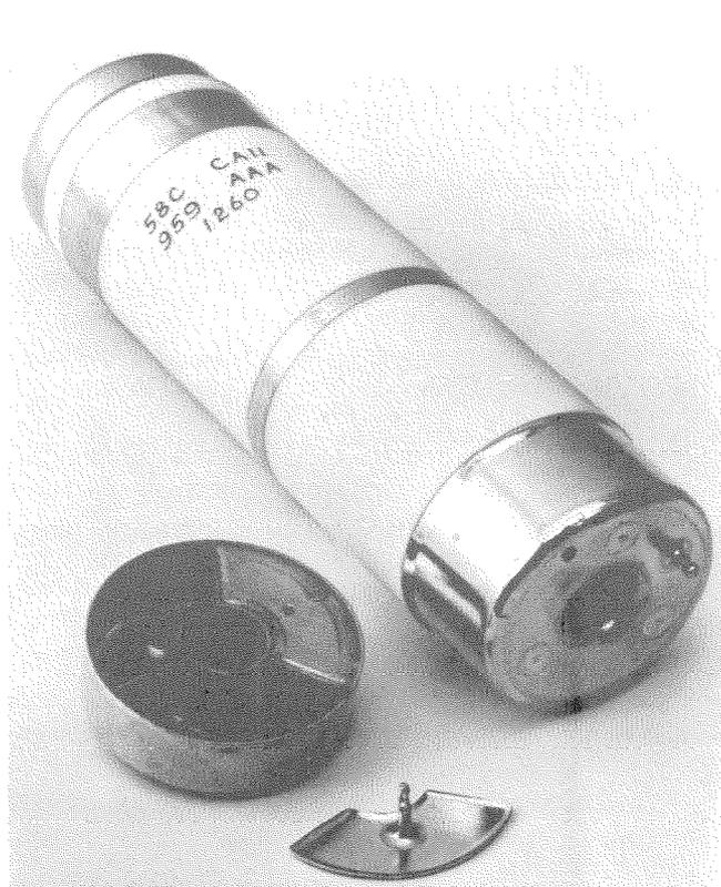
Fig. 5 Vista de un condensador coaxial de alta tensión para filtros separadores de fuerza, mostrando la trampa de aire dividida en segmentos.
