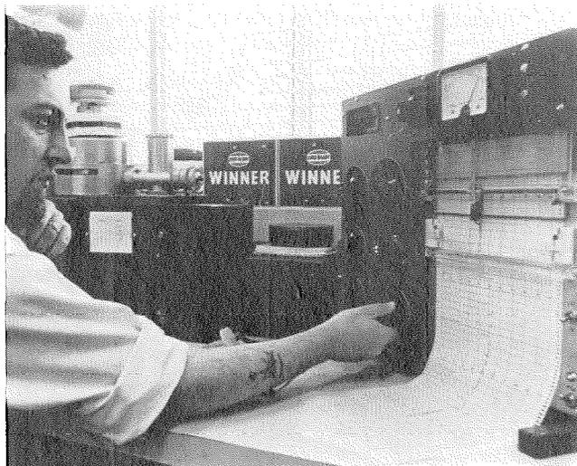
Fig. 4 Medida del factor de potencia de polietileno.
