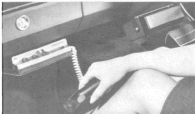
Fig. 1 Radiotéléfono "STAR" de UHF instalado debajo del tablero de un vehículo. El micrófono es del tipo supresor de ruidos.
