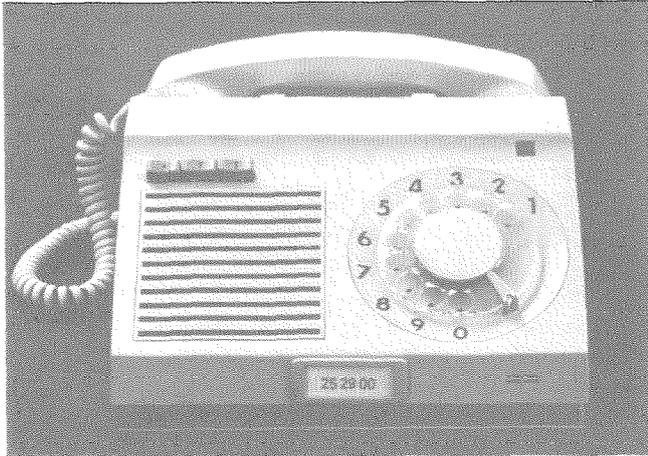
Fig. 1 Aparato de alta voz con disco.
