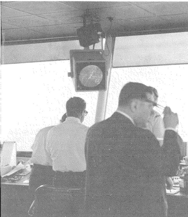
La pantalla de radar BRITE puede observarse en la torre de control de un aeropuerto sin necesidad de reducir la gran iluminación del exterior por persianas.
