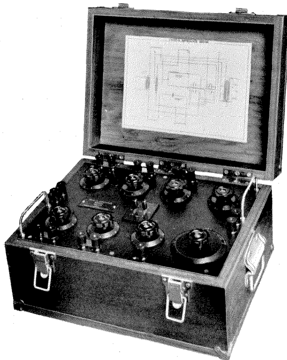
Fig. 12—74102-A Impedance Bridge.
