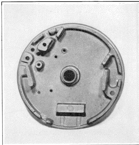
*Figure 15—Aluminium Die Cast Back Plate for Dial.*
